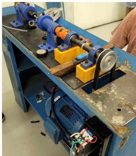
Figura 3 – Bancada de ensaio de fadiga.
