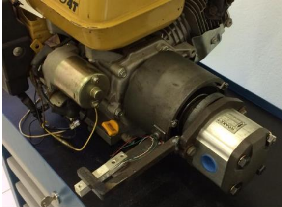
Figura 4 – Bancada do dinamômetro hidráulico.
